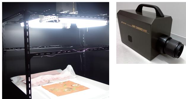
図1（左）測定風景（右）2次元分光放射輝度計（SR5000H）
