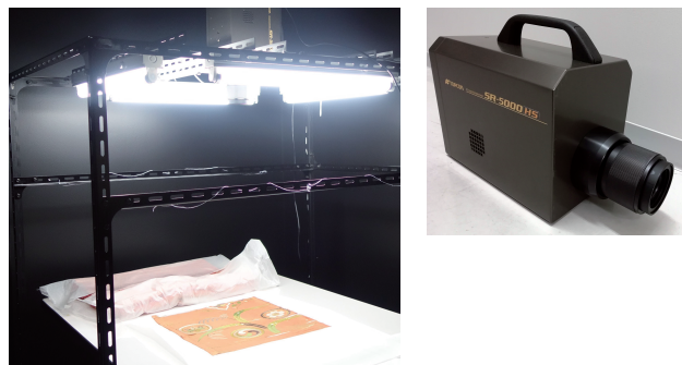
図1（左）測定風景（右）2次元分光放射輝度計（SR5000H） 暗室内にアングルを組み立て、アングル上部に2次元分光放射輝度計を設置。
